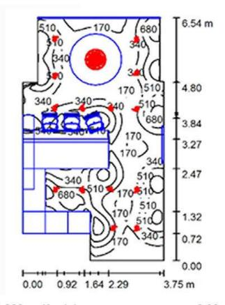
Высота помещения: 2.800 m, Коэффициент эксплуатации: 0.80
